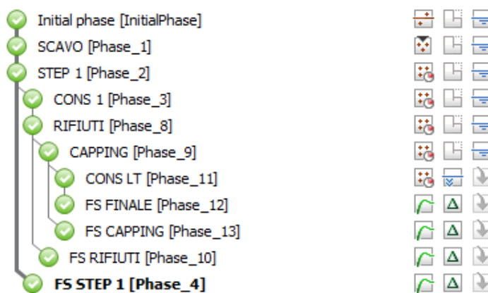
Figura 6.6 Fasi di calcolo per le sezioni arginali
